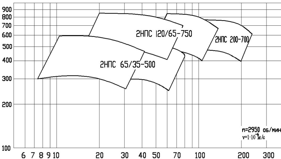
Возможно расширение этих полей за счет применения специально разработанных гидравлик в корпусах стандартных насосов.
